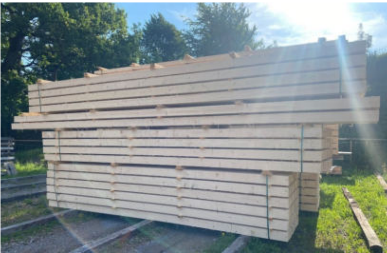
bis zu 13 m lange Vollhölzer aus Fichte für die Balkenlagen
