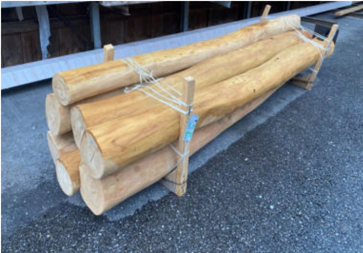
Entrindete Rundhölzer aus Robinie für die Pfahlstützen
