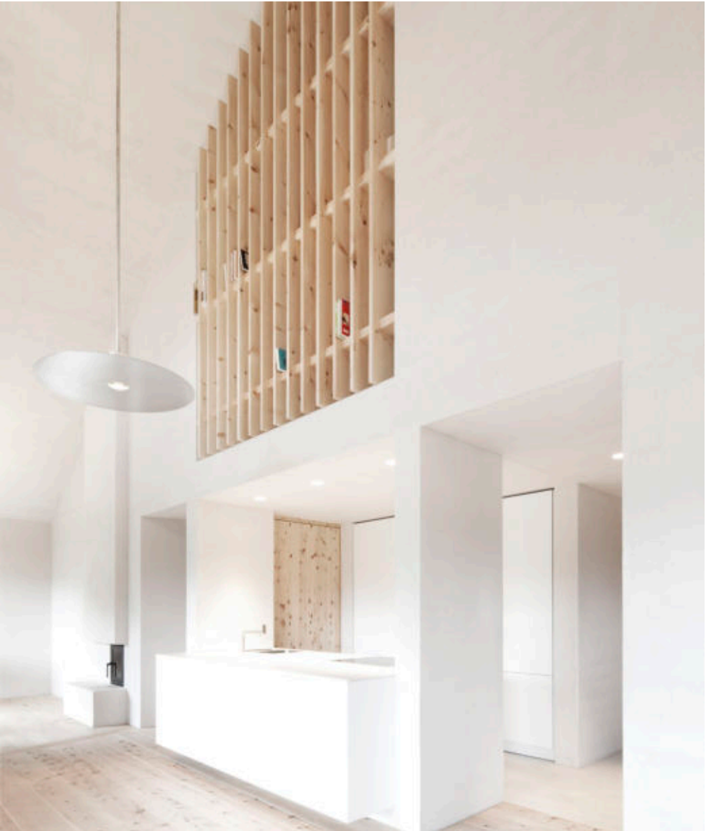
Reduktion auf zwei Materialien: Sichtbeton aus Dolomitgestein, unbehandelte massive Zirbe.
