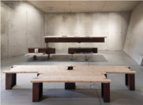
Endstand: Detail Bänke und Ausstellungs Möbel aus den Metallträgern des ursprünglichen Gebäudes gefertigt
