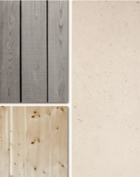
Bauen nur mit dem, was vor Ort verfügbar ist. Dolomitgestein, Zirbe, Lärche. Minimaler Aufwand, maximale Beständigkeit. Passive Klimastrategie mit Speichermasse und Phasenverschiebung statt Technik.
